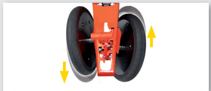
Desalineación de las ruedas Mejora el paso de los residuos y de la tierra entre las ruedas, minimizando el riesgo de acumulación de cuerpos extraños
