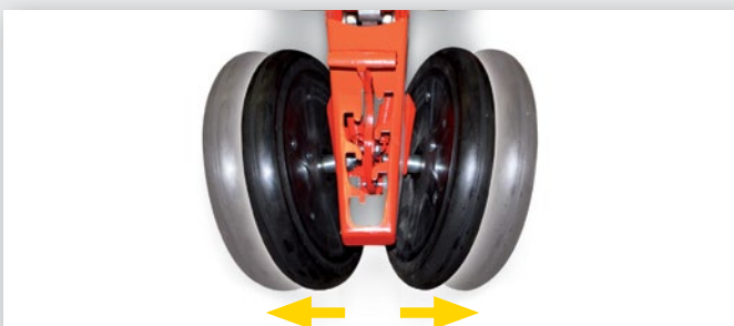
Distanciamiento de las ruedas Optimiza el cierre del surco en función de la profundidad de siembra y evita que se formen oclusiones y acumulación de residuos de cultivos o piedras.
